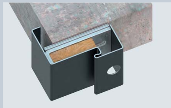
1. Zarge in die Öffnung stellen und ausrichten
