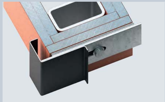
2. Eckzargen-Profil mit dem Ständerwerk verschrauben
