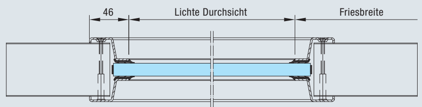
Aufgesetztes Stahlprofil in Grauweiß, RAL 9002 (Standard)
