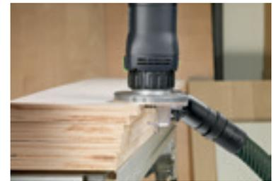
Fasefräsen von Kunststoff- oder Massivholzleimern.
