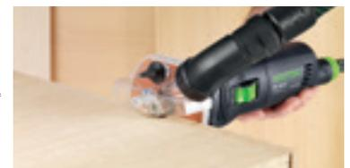
Bündigfräsen von Kunststoff- oder Massivholzleimern.
