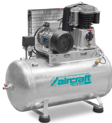
AIRPROFI 853/200/10 H 2-Zylinder-Kompressor auf 200 Liter Druckluft-Behälter
