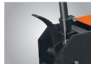
Zusätzliches Fußpedal zum Heben mit Schnellhub
