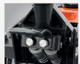
Quick-Lift Funktion durch Doppelkolben
