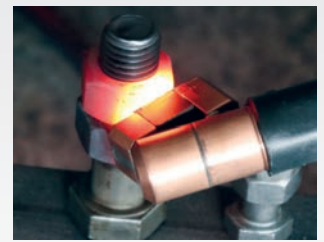
› Erwärmen einer Mutter mit der Fokusspule schräg
