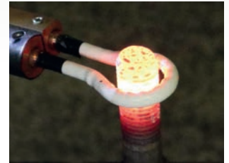
› Erwärmen eines Gewindebolzens mit der wassergekühlten Spule
