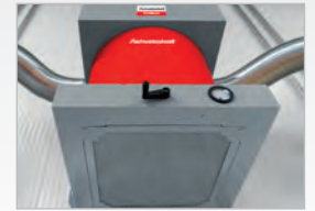
Integrierte Hebevorrichtung für den Filterwechsel
