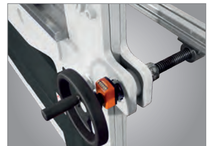
Verstellung des Hinteranschlags über Handrad mit Zählwerk
