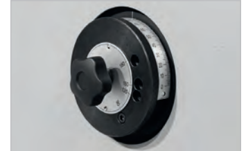
serienmäßige Steuerung MA – manuelle Verstellung des Biegewinkels mittels Skalenring an der linken Maschinenseite
