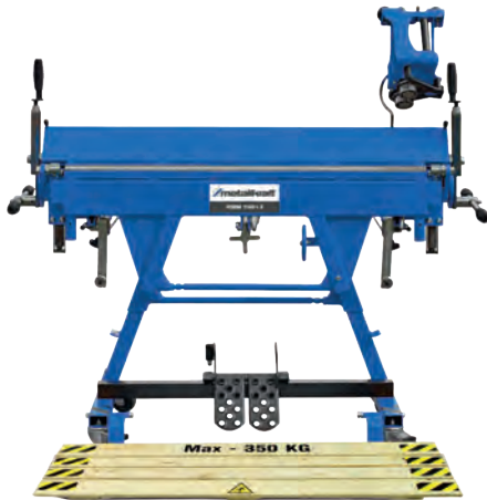
HSBM 1160-1,5 Abbildung zeigt optionales Zubehör: Trittauflage aus Holz (Art Nr: 3792093) Fußpedal für Oberwange (Art Nr: 3792092)
