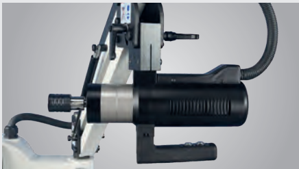
▶ Maschinenkopf von 0 bis 90 Grad schwenkbar
