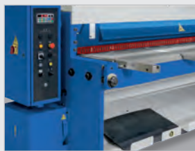
▶ Bedienpult an der linken Maschinenseite
