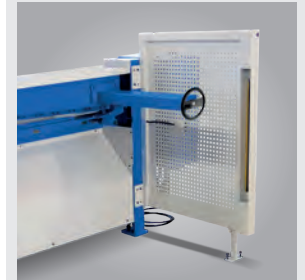
▶ Rückraum durch Lichtschranke abgesichert
