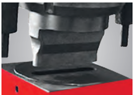
▶ Optionale Stanzeinrichtung für große Durchmesser
