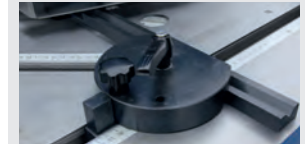
▶ Exakte Winkeleinstellung mithilfe von Anschlägen und Skalen
