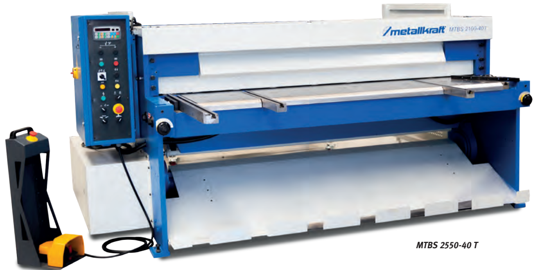
▶ Rückraumsicherung nach CE mit Seitenblechen und Lichtschanke
