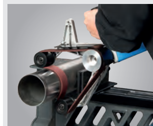
▶ Nur zwei Arbeitsschritte notwendig für 360° Umfangschleifen
