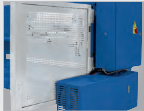
▶ Rückraumsicherung nach CE mit Seitenblechen und Lichtschanke
