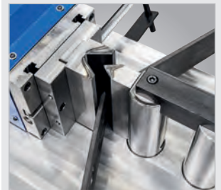
▶ Mit Schnellwechselaufnahme und Seitenanschlag mit Skala
