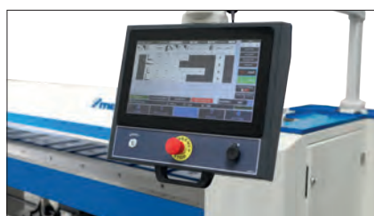
Bedienerfreundliche 15,6“ Touchscreen NC-Steuerung an ergonomischen Schwenkarm
