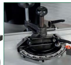
Stufenlos verstellbarer Winkelanschlag
