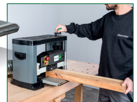
Höheneinstellung über Handkurbel und Skala
