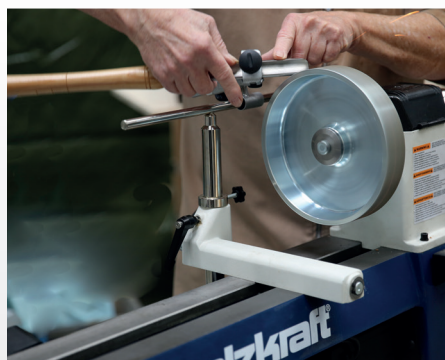
Abb. Schärfen von Werkzeug direkt an der Drechselmaschine
