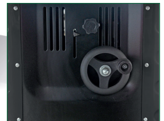
Spindelhöhe von 0 bis 40 mm einstellbar
