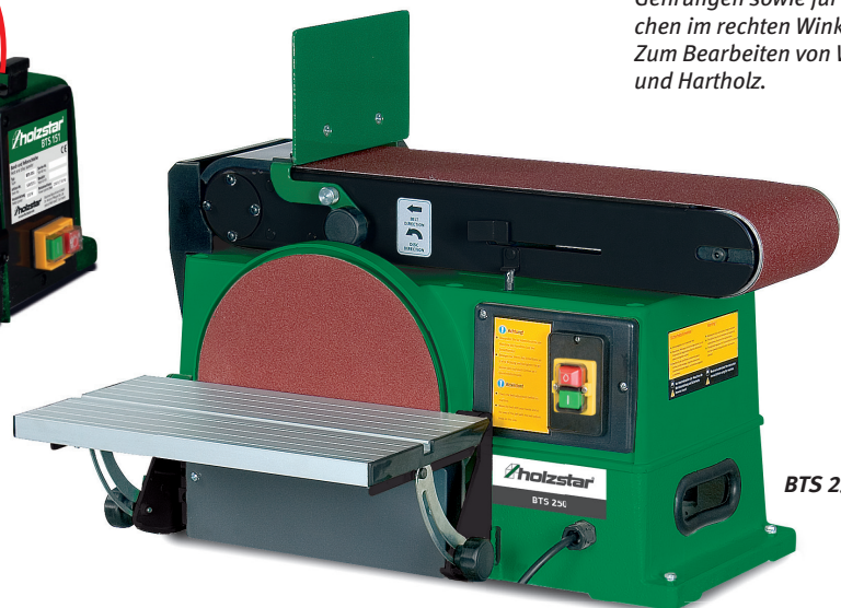
BTS 151 Mit geschwenktem Schleifaggregat. Der Tisch kann ebenfalls geschwenkt werden.
