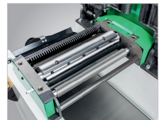
Stabiles Hobelwerk mit Dreimesserwelle
