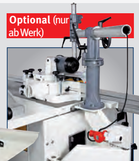
Optional (nur ab Werk) Schwenkarm mit Steckdose · zur Anbringung eines Vorschubapparates Art.-Nr.: 5510510
