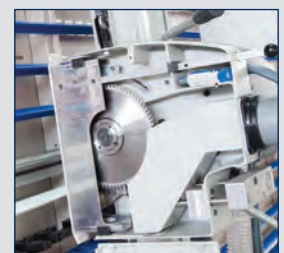
· Große Öffnung für Sägeblattwechsel
