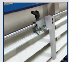
· Lineal zur Längeneinstellung beim Vertikalschnitt
