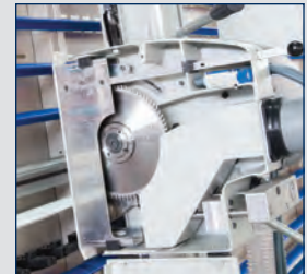
· Große Öffnung für Sägeblattwechsel
