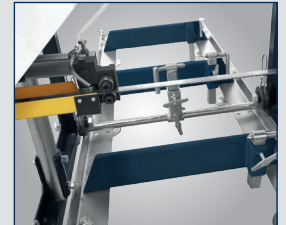
· Verstellbare Sägebandführung für einen präzisen Sägeschnitt
