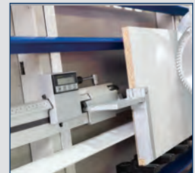
· Digitale Maßanzeige zur Längeneinstellung beim Vertikalschnitt
