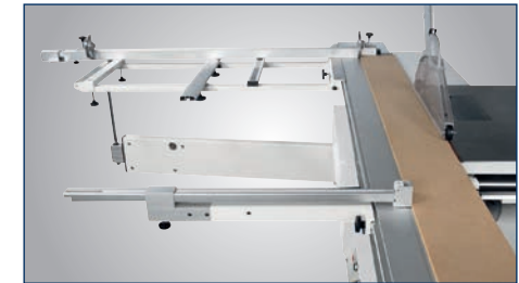
Zusätzlicher Parallelanschlag ► am Formatschiebetisch für lange und schmale Werkstücke
