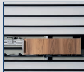
• Durchgängige mittlere Werkstückauflage mit digitalem Längsanschlag für höchste Präzision
