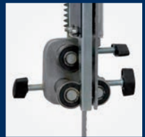
Sägeband-Präzisionsführung oben und unten
