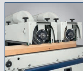
Arbeitsaggregate können einzeln zugeschaltet werden
