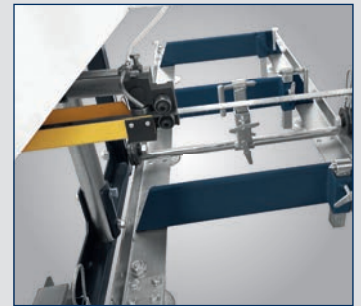
· Verstellbare Sägebandführung für einen präzisen Sägeschnitt
