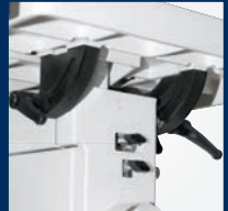
Sägetisch mit Schwenkeinrichtung aus Grauguss, schwenkbar bis 20°
