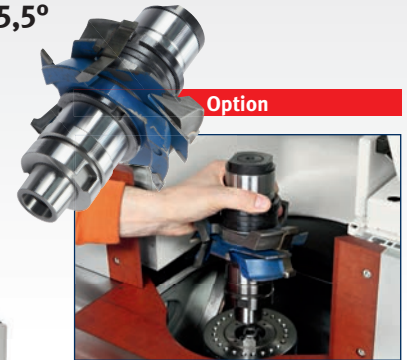
· Auswechselbare Spindel Version HSK, Art.-Nr. 5256214
