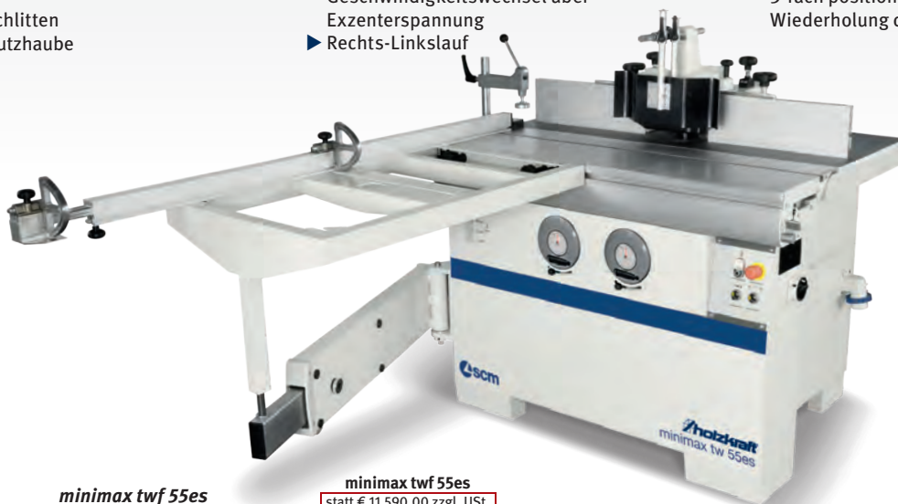
minimax twf 55es Abb. mit optionaler Tischverlängerung
