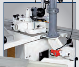
Schwenkarm mit Steckdose · zur Anbringung eines Vorschubapparates Art.-Nr.: 5510510
