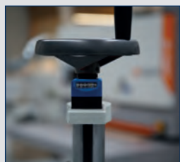
Zählwerk für die präzise Höheneinstellung
