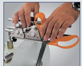
Vorrichtung für Scheren Art.-Nr. 5760058
