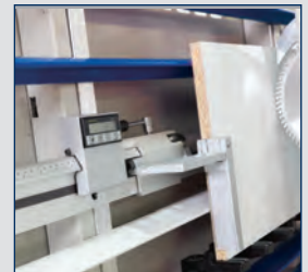
· Digitale Maßanzeige zur Längeneinstellung beim Vertikalschnitt
