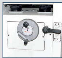
Dickentischverstellung • über Handrad mit integrierter Anzeige
