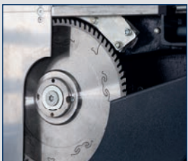
• Durchzugkräftiges 3kW Sägeaggregat mit Vorritzer und 60 mm Schnitttiefe
