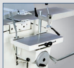
Langlochbohrereinrichtung in Guss-Ausführung Art.-Nr.: 5514330
