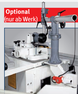
Schwenkarm mit Steckdose zur Anbringung eines Vorschubapparates Art.-Nr.: 5510510
