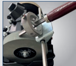
Vorrichtung für Rohren und Hohleisen Art.-Nr. 5760166
