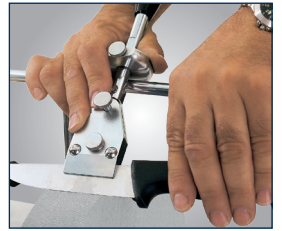
Vorrichtung für kleine Messer Art.-Nr. 5760056
