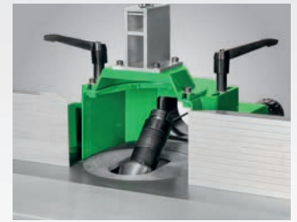
TF 190SE mit schwenkbarer Frässpindel -5° bis +30°
