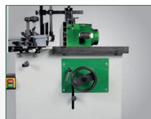
Handrad für Höhenverstellung. Sicherheitsvorrichtungen im Lieferumfang
