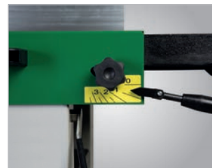
Verstellung der Spanabnahme über Bedienhebel
