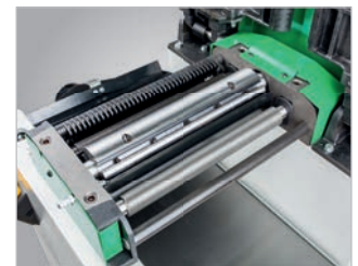
Stabiles Hobelwerk mit Dreimesserwelle
