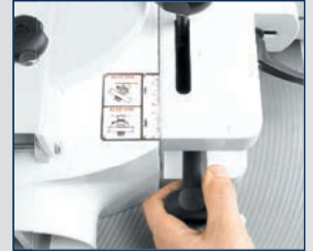
Exakter Fräsanschlag mit einer Schnellverstellung und einer Feineinstellung mit Skala an der Anschlagbacke
