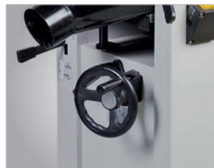
Dicketischverstellung über Handrad, Skala und numerischer Anzeige
