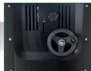
Spindelhöhe von 0 bis 40 mm einstellbar
