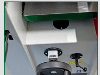
Dickentisch Führung auf mittlerer Säule und Zusatzführung Höhenverstellung über Handrad Höhenanzeige durch mechanisches Zählwerk mit Genauigkeit 0,1 mm
