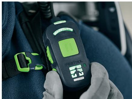
Für eine bequeme Steuerung verfügt das Exoskelett über drei vordefinierte Arbeitsbereiche: ab Becken aufwärts, ab Brust aufwärts oder über Kopf.
