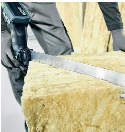
Flexibel für Dämmstoffe bis zu 350 mm Dicke.
