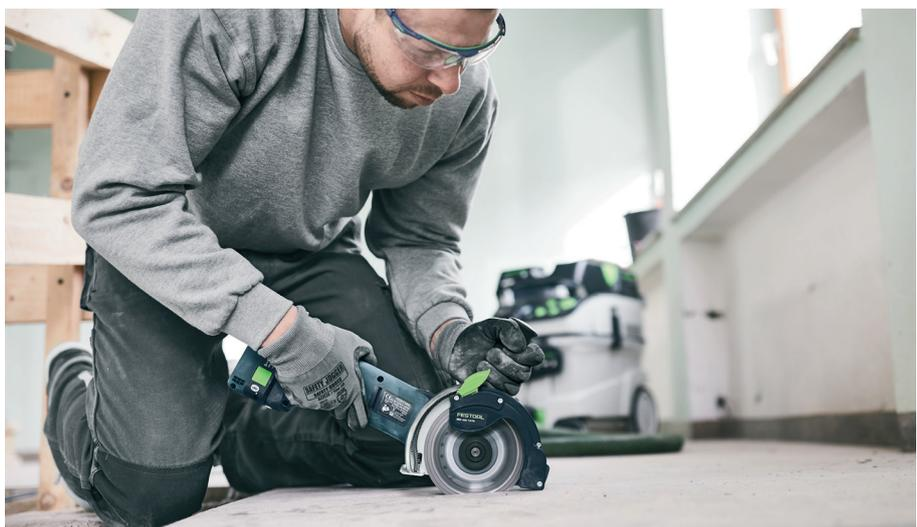
Absaughaube befördert > 95 % des Staubs direkt zum angeschlossenen Absaugmobil.
