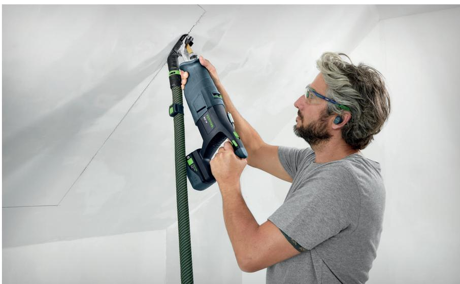
Die im Lieferumfang enthaltene Absaugvorrichtung wird werkzeuglos am Säge Tisch befestigt. Unangenehmer Feinstaub und Sägespäne werden bei angeschlossenem Sauger direkt am Entstehungsort abgesaugt.
