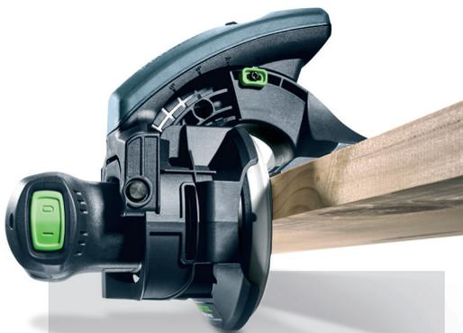
So gelingt die optimale Kante: Der Kantenschleifer liegt vollflächig an der Kante an und sorgt für einen einwandfreien Schliff. Kein Abkippen und kein Durchschleifen – ab der ersten Anwendung. Geeignet für kleine als auch große Werkstücke, schmale und breite Kanten (5-60 mm), schräge Flächen (43-92°) sowie Außenrundungen in der Kontur (z. B. bei einem runden Esstisch). Arbeiten ist bis in Innenecken möglich.
