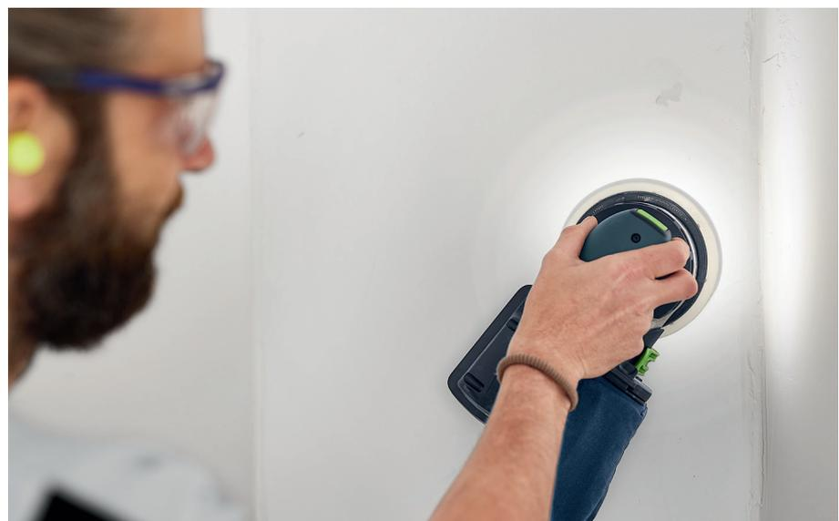
Der integrierte LED-Lichtring verbessert die Sicht auf die Oberfläche und macht Unebenheiten leichter erkennbar.
