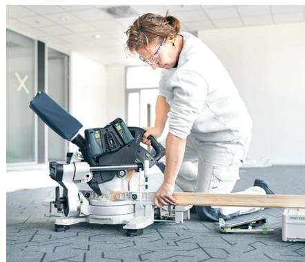
Die Zusatzfüße erhöhen den Arbeitstisch der KSC 60 exakt auf die Höhe des Systainers SYS 3 M 112 bzw. SYSTAINER SYS 1
