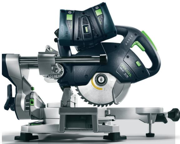
Die Akku-Kapp-Zugsäge KAPEX KSC 60 liefert unschlagbar präzise Kappschnitte. Und das in einer enormen Anwendungsvielfalt durch beidseitige Gehrungswinkel bis zu 60 Grad und beidseitige Neigungswinkel bis zu 46 bzw. 47 Grad.
