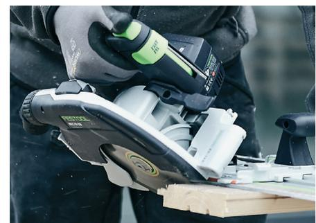
Kappschiene mit Anschlagssystem für wiederholgenaue Winkelschnitte.
