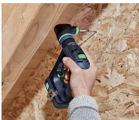
Die Tiefenanschläge und der Exzentervorsatz ermöglichen zusätzlich tiefenbegrenztes und randnahes Schrauben.
