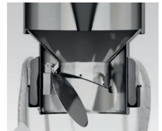
Verschlussklappe schließt automatisch, solange der Sauger außer Betrieb ist. So wird ein Nachrutschen von Staub beim Entsorgen des Sammelbeutels verhindert
