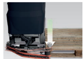
Reinigungsbürsten mit automatischem Einzug bei Stößen
