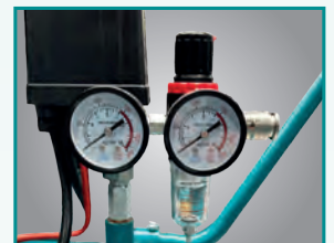
Filterdruckregler zur stufenlosen Einstellung des Arbeitsdrucks, bei gleichzeitiger Schmutz-, Öl- und Kondensatabscheidung
