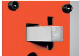
▶ Profilstahlschere / Vierkantstahlmesser
