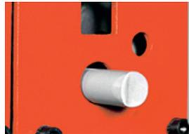
▶ Profilstahlschere / Rundstahlmesser
