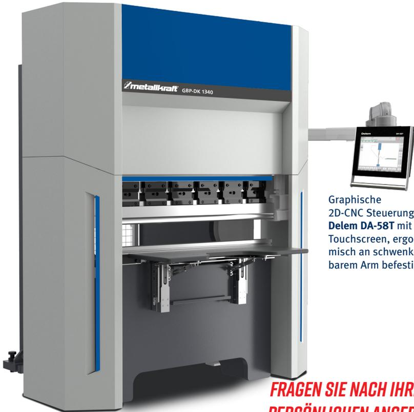
Graphische 2D-CNC Steuerung Delem DA-58T mit Touchscreen, ergonomisch an schwenkbarem Arm befestigt
