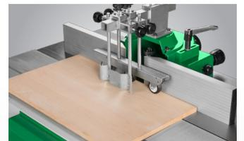
Fräsanschlag mit feineinstellbaren Aluminium-Anschlägen
